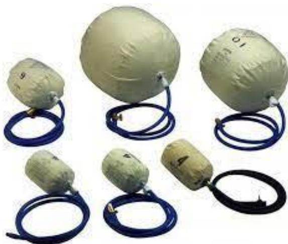
Les obturateurs gonflables Toile permettent d'obturer des réseaux de tuyauterie ou gaine de ventilations. Ils sont employés pour des épreuves d'étanchéités, des travaux de maintenance et cela afin d'éviter des retours de produits dangereux.
